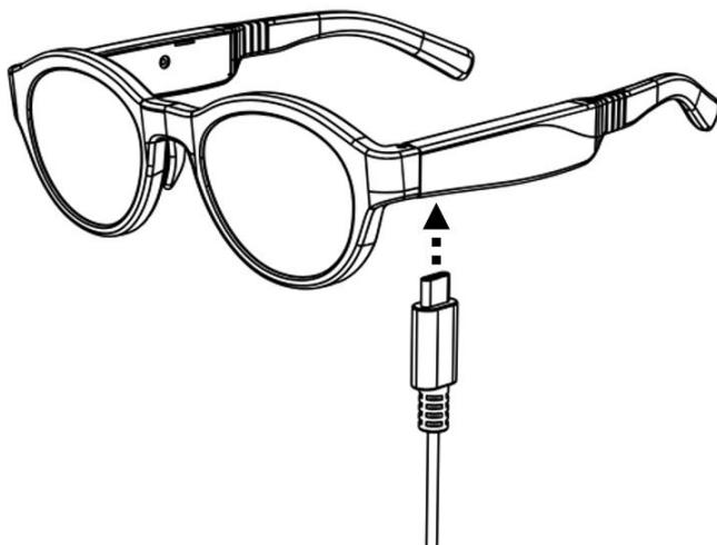
La LED de la branche gauche est orange si la batterie est en charge et devient verte quand la batterie est suffisamment chargée.
