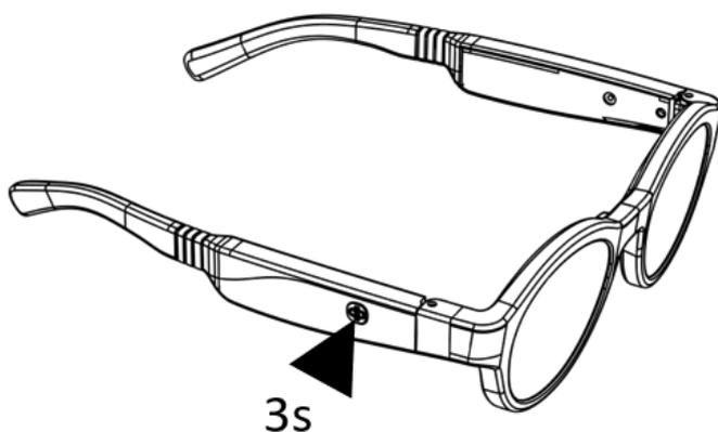
Restez appuyé pendant 3 secondes sur le bouton ON/OFF. Le Bluetooth® s'active quand la LED de la branche droite clignote en bleu. La LED devient bleu fixe quand la Lexilens® est connectée à votre application smartphone.
