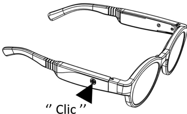
Appuyez une fois sur le bouton ON/OFF. Les verres de la LEXILENS© deviennent opaques. La LED s'allume vert pendant 5 secondes si la batterie est suffisamment chargée, ou clignote rouge si la batterie doit être rechargée.
